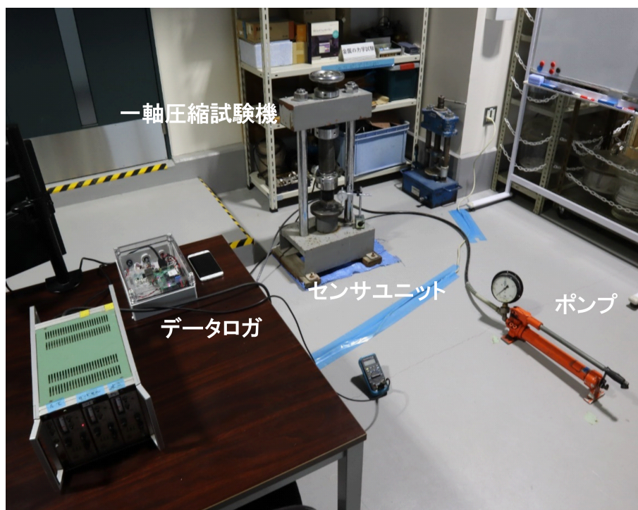
図4.4 荷重応答試験の様子
