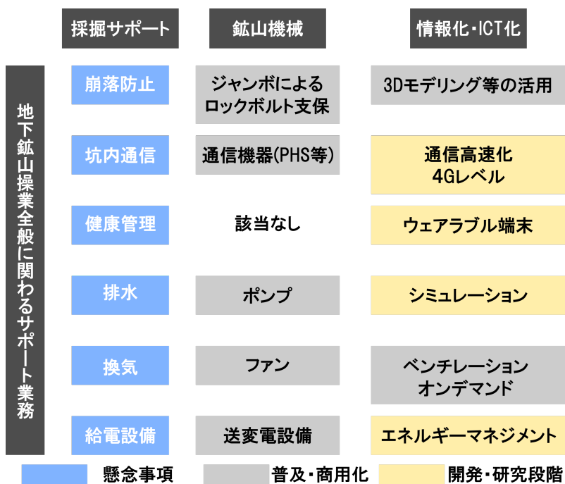
図2.3 坑内掘鉱山内の情報化
