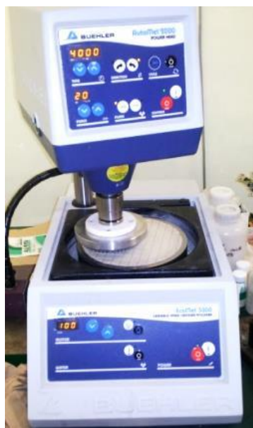
図 3-8 しゅう動実験に用いた卓上研磨装置
