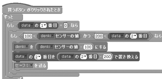
図19 「電気を買うボタン」の自動化プログラム
