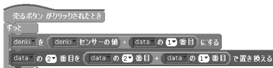
図11 誤って反復処理を加えたプログラムの例
