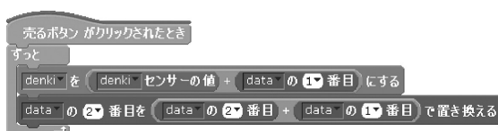
図18 「電気を買うボタン」の自動化プログラム
