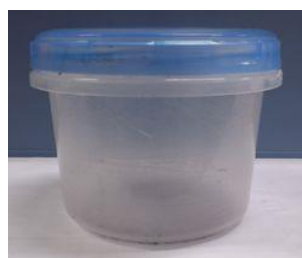
(a) 以前の処理容器 (内径 60 \phi , 高さ 60 mm)
