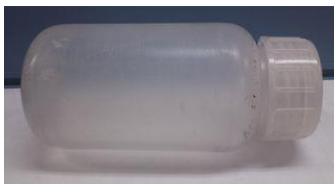
(b) 新処理容器(横向きで利用) (本体：内径 60 \phi , 高さ 100 mm キャップ：内径 40 \phi , 高さ 20 mm)
