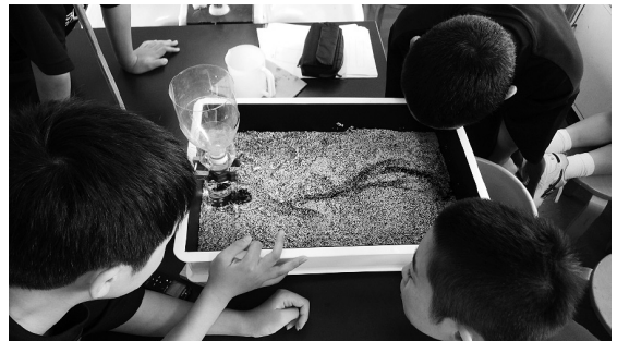
図1 卓上型流水の働きモデル実験装置を用いた洪水災害のモデル実験(流路の観察)の様子
