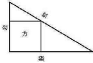
(現代訳) ここに図のように直角三角形内に正方形が接している。直角三角形の直角を挟む辺それぞれの長さが3寸、4寸であるとき、正方形の一辺の長さを求めなさい。
