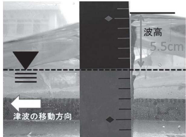
図9 津波の波高の読み取り（波線は静水位）
