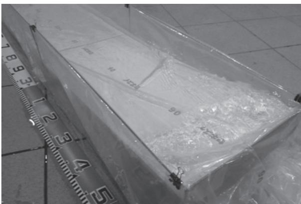
図7 浅海・海岸部（海岸平野）にビニールをかぶせ水を張った状態
