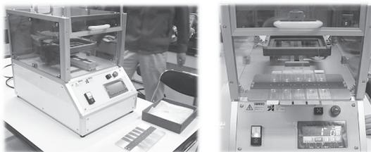
図4. 迅速免疫染色実験装置の試作機
