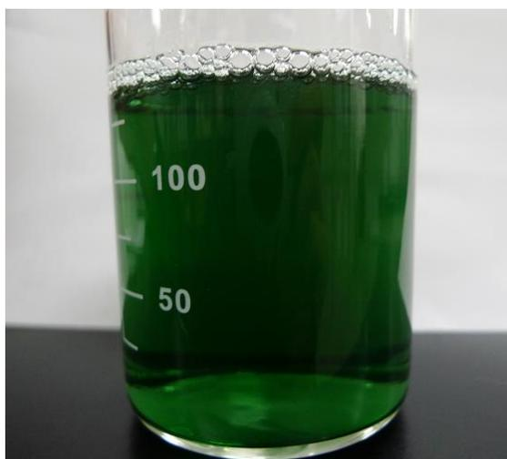
Fig. 3.22 粉碎基板の加圧酸浸出液 の写真
