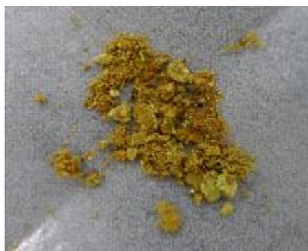
Fig. 2.20 反応管出口部に固化（析出）した揮発物の写真
