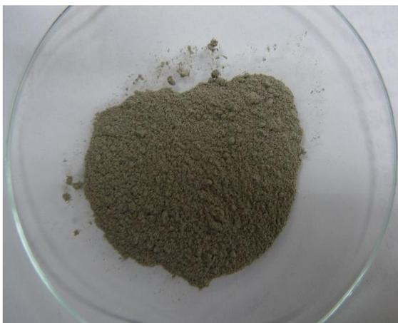
Fig. 3.23 粉碎基板の浸出残渣の写真
