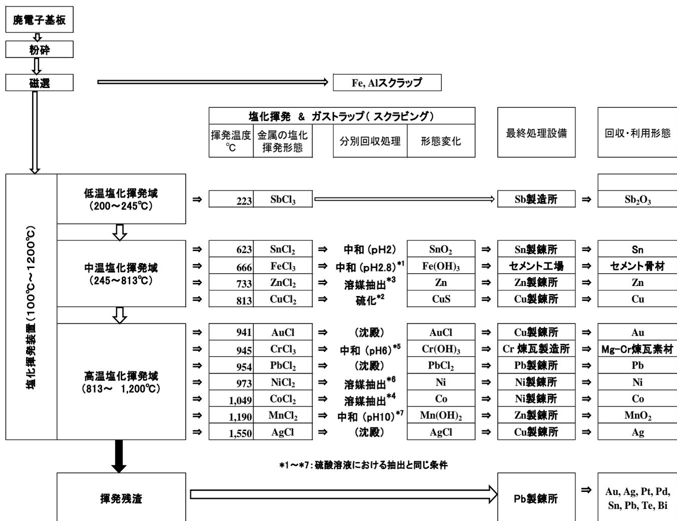
Fig. 4.1 塩化揮発法を利用した廃電子基板からの含有金属のリサイクルフロー図
