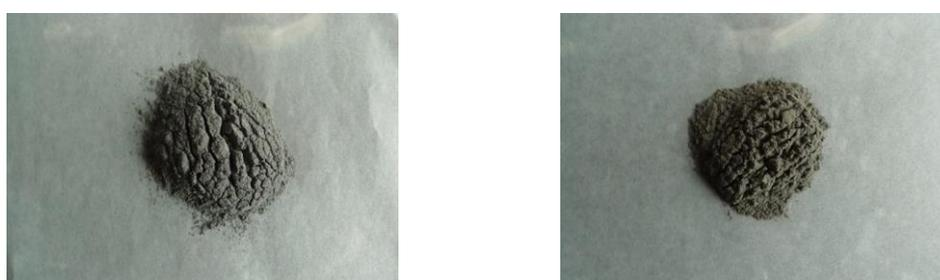
Fig. 2.1 廃電子基板試料 (左：粉碎基板 右：基板焼却灰)
