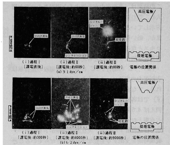
図 13 表面張力が異なる場合における トラッキング破壊までの放電および 炭化路の発生状態 (EX, 4.5 kV)
