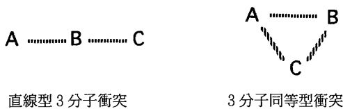
図8 3分子反応の2つの可能性の各分子の幾何学的配置
