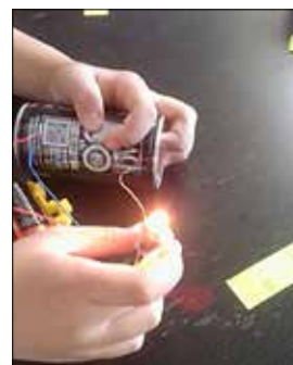
【図6 削った空き缶は電気を通した。】
