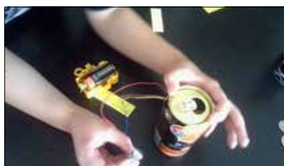
【図4 空き缶は素材がアルミニウムや鉄でも電気を通さなかった。】
