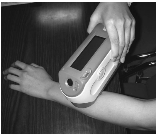
図1. 分光測色計(コニカミノルタ社製 CM2500d)
