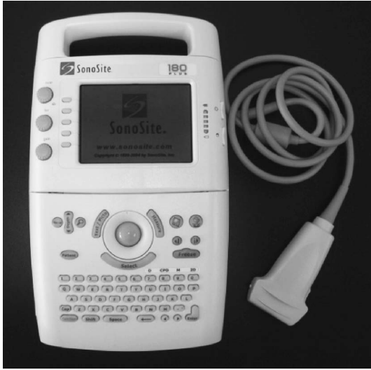
図3. 超音波診断装置 (SonoSite 社製, SonoSite-180PLUS) とリニアプローブ (SonoSite 社製, L38/10-5)
