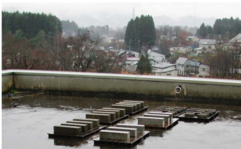
図 2-4-1 RC 建築物の屋上における供試体暴露状況（秋田県大館市）
