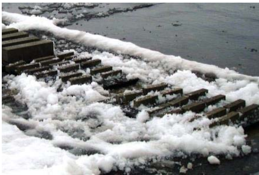
図 2-3-1 モルタル供試体の冬期暴露状況（秋田県大館市）
